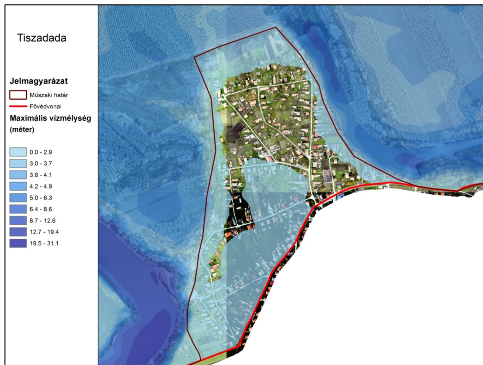
2-18. ábra: A tiszadadi beépített területen az 1%-os mértékadó helyzetben kialakuló legnagyobb vízmélységek
