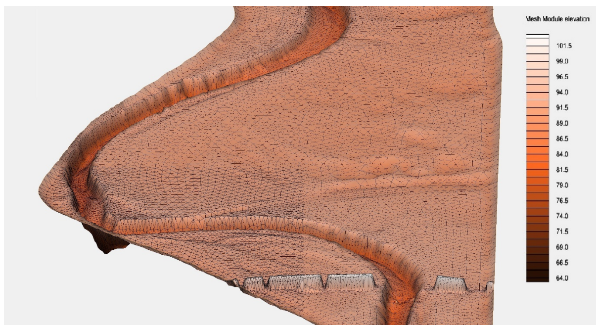
2-9. ábra: Perspektivikus árnyékolt kép a Tiszapalkonya és Polgár környéki számítási rácshálójáról a terepmodell és a rácsháló feltüntetésével
