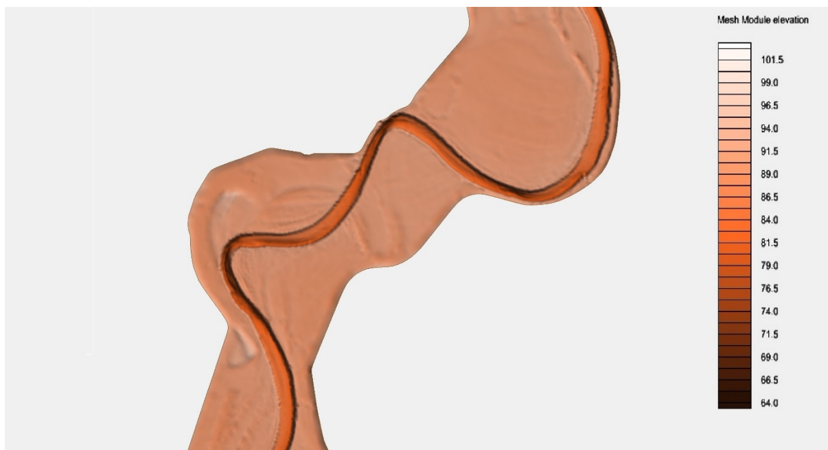
2-7. ábra: Felülnézeti kép a Tiszakeszi környéki számítási rácshálójáról a terepmodell feltüntetésével
