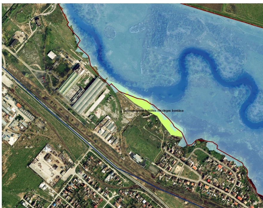
3-3. ábra: Sajószentpéteri feltöltés részleges bontása, mely után a nagyvízi mederhatár módosulni fog
