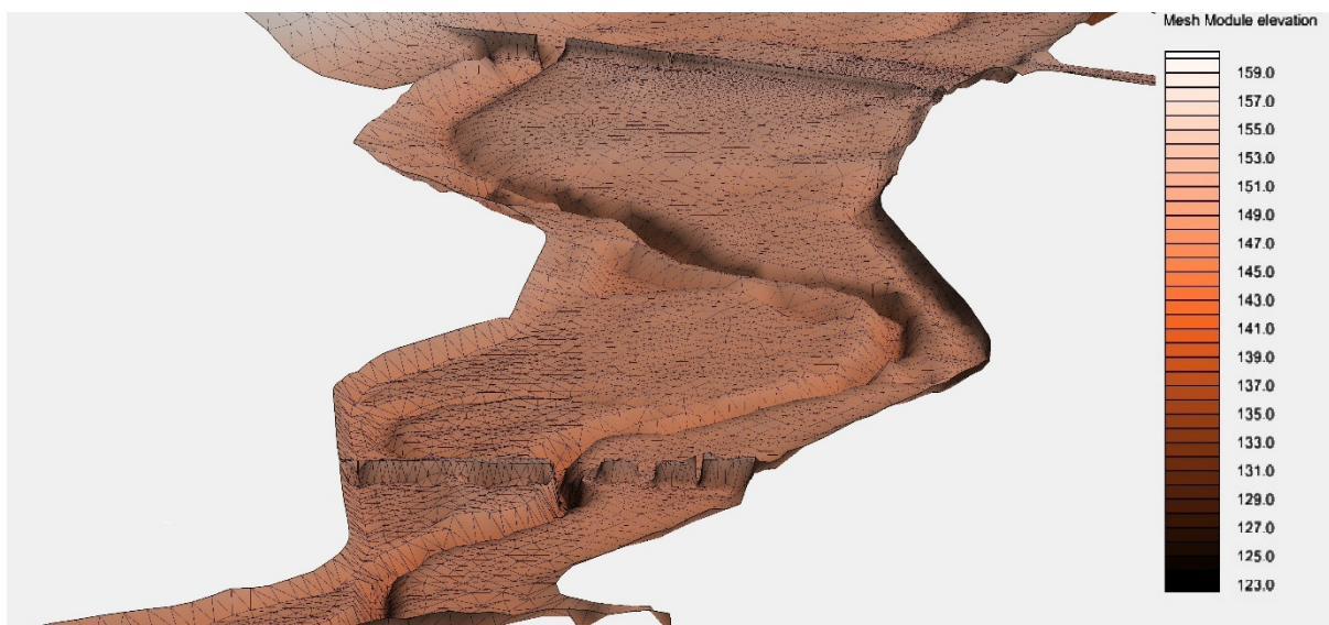
2-9. ábra: Perspektivikus árnyékolt kép Sajónémeti és Sajópüspöki környéki számítási rácshálójáról a terepmodell és a rácsháló feltüntetésével
