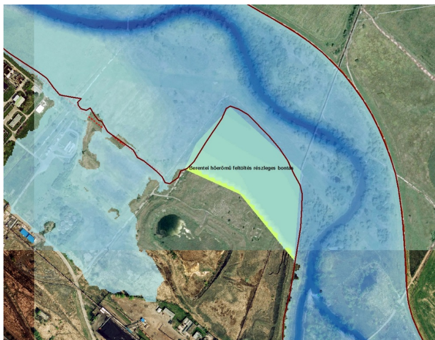
3-2. ábra: Berentei hőerőmű zágtér feltöltés részleges bontás, mely után a nagyvízi mederhatár módosulni fog
