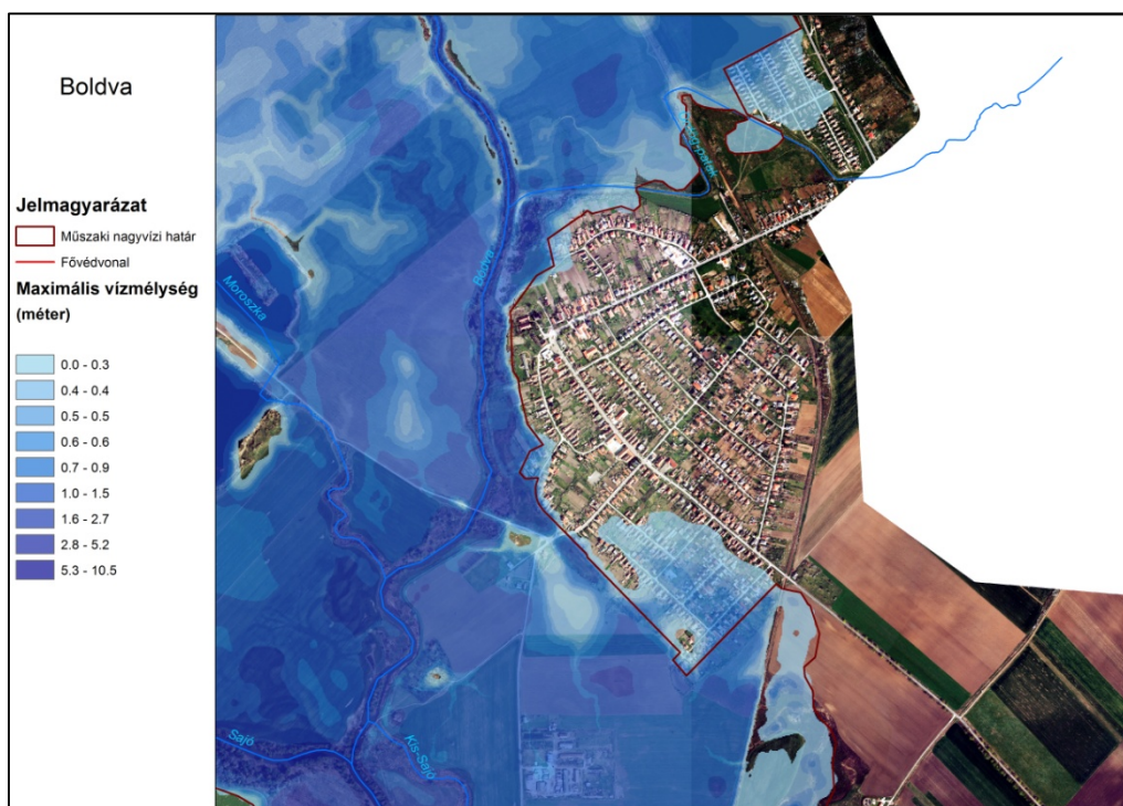
2-22. ábra: A boldvai beépített területen az 1%-os mértékadó helyzetben kialakuló legnagyobb vízmélységek
