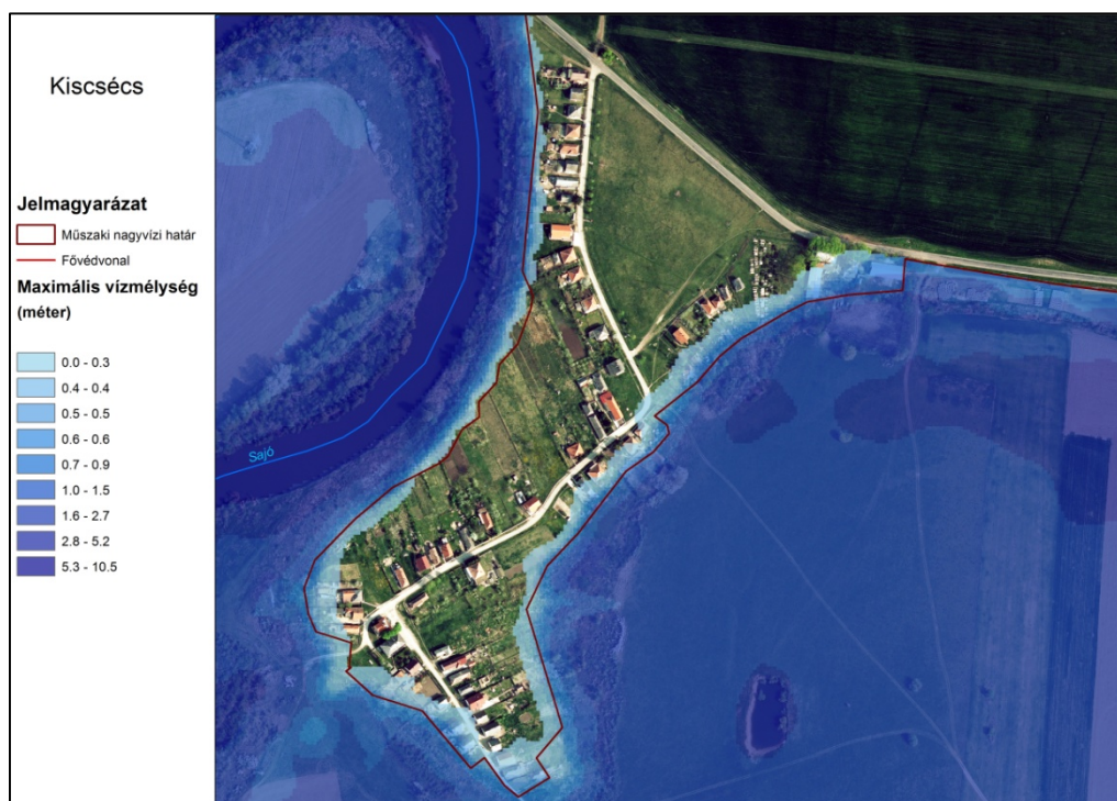
2-26. ábra: A kiscsécsei beépített területen az 1%-os mértékadó helyzetben kialakuló legnagyobb vízmélységek
