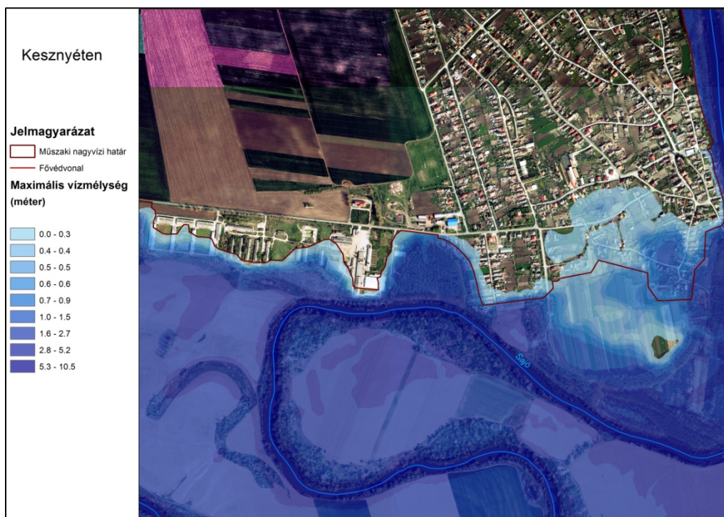
2-25. ábra: A kesznyéteni beépített területen az 1%-os mértékadó helyzetben kialakuló legnagyobb vízmélységek
