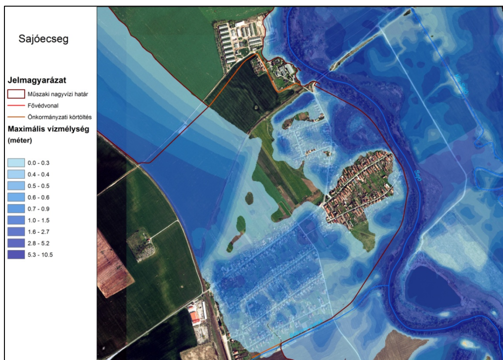
2-29. ábra: A sajóecsegi beépített területen az 1%-os mértékadó helyzetben kialakuló legnagyobb vízmélységek
