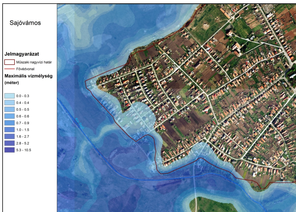
2-36. ábra: A sajóvamosi beépített területen az 1%-os mértékadó helyzetben kialakuló legnagyobb vízmélységek
