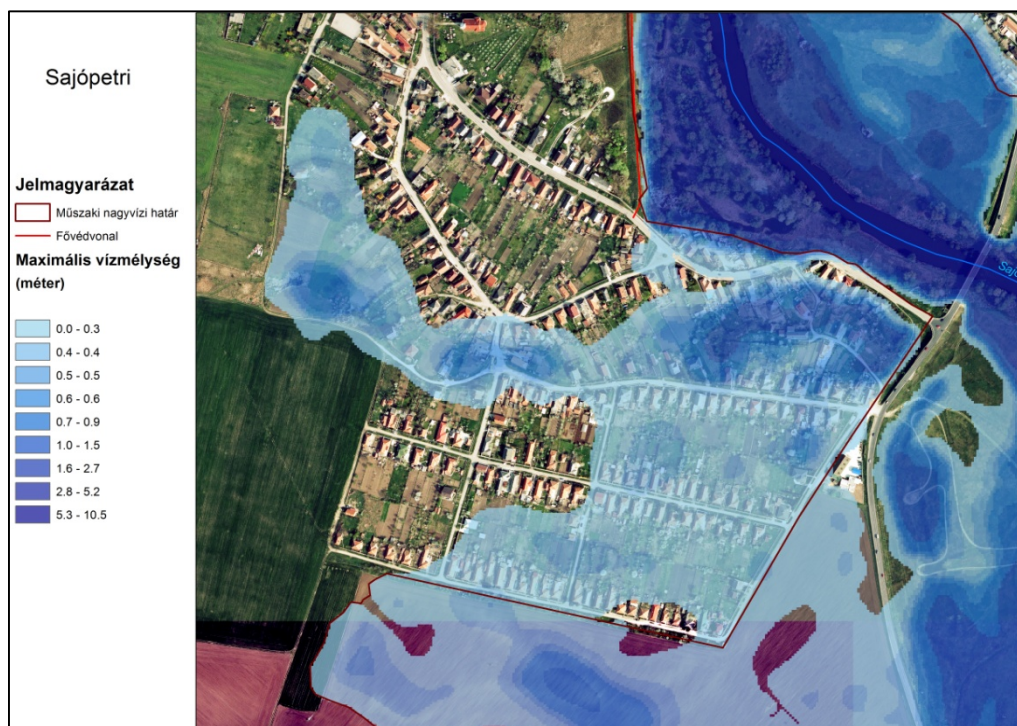
2-33. ábra: A sajópetri beépített területen az 1%-os mértékadó helyzetben kialakuló legnagyobb vízmélységek
