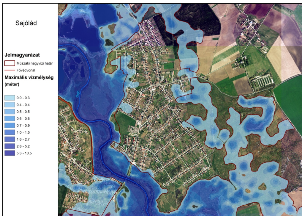
2-31. ábra: A sajóládi beépített területen az 1%-os mértékadó helyzetben kialakuló legnagyobb vízmélységek
