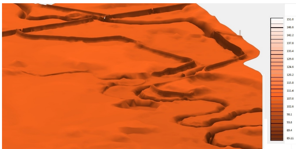
2-8. ábra: Perspektivikus árnyékolt kép Bőcs környéki számítási rácshálójáról a terepmodell feltüntetésével
