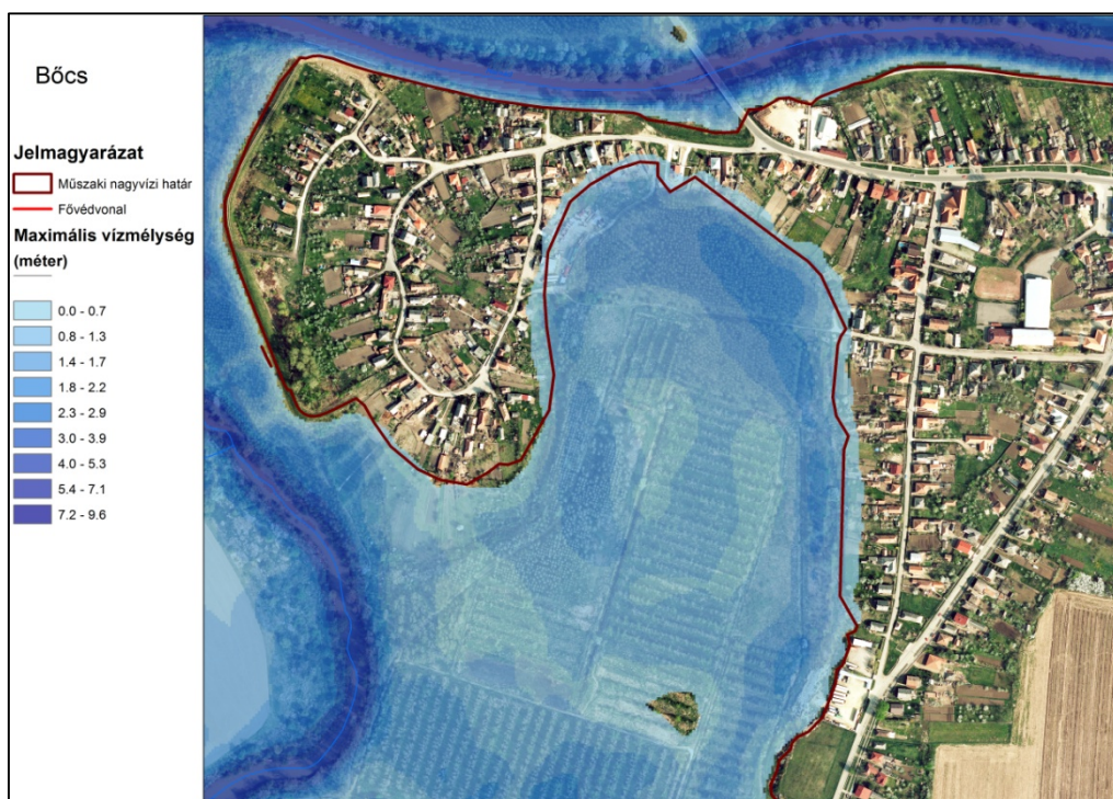
2-19. ábra: A bőcsi beépített területen az 1%-os mértékadó helyzetben kialakuló legnagyobb vízmélységek
