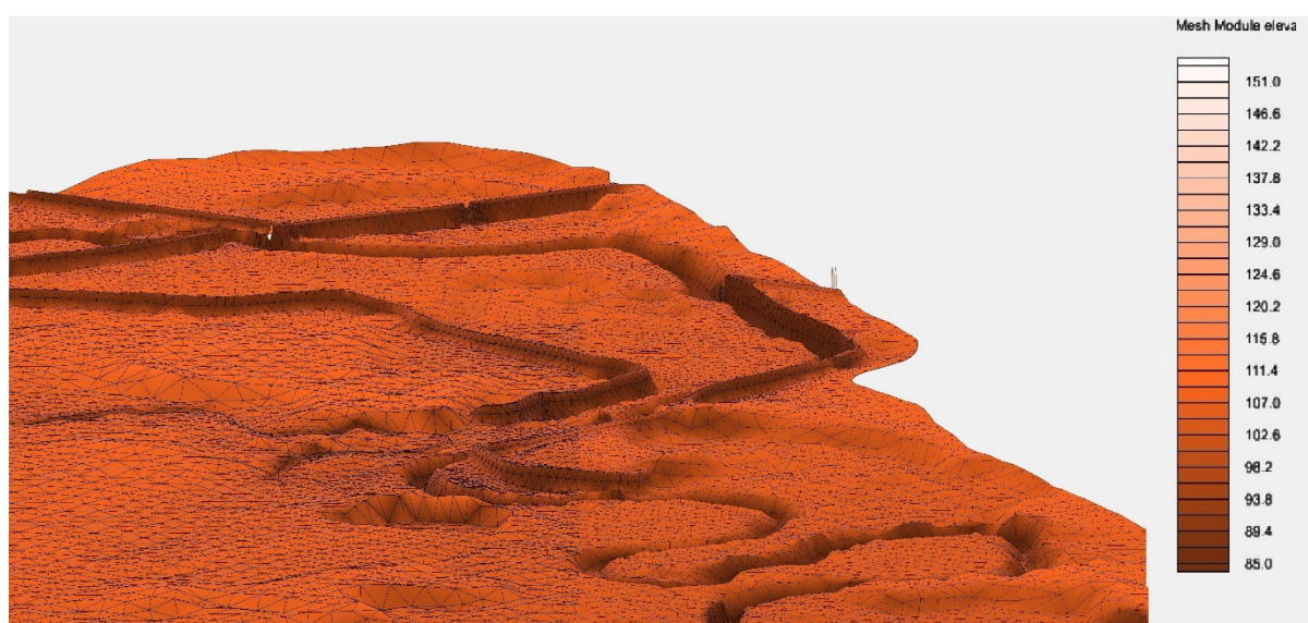
2-9. ábra: Perspektivikus árnyékolt kép Bőcs környéki számítási rácshálójáról a terepmodell és a rácsháló feltüntetésével
