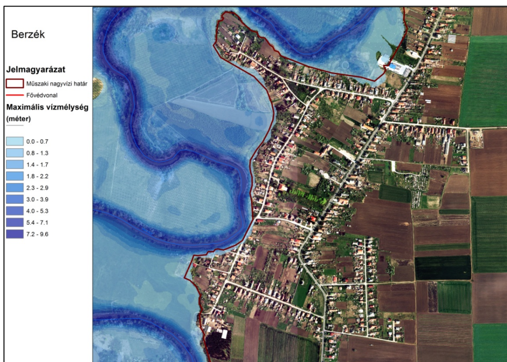
2-20. ábra: A berzéki beépített területen az 1%-os mértékadó helyzetben kialakuló legnagyobb vízmélységek
