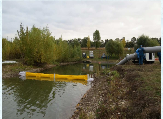
2. kép SUPERMAX I. típusú poliuretánnal töltött merülőfal
