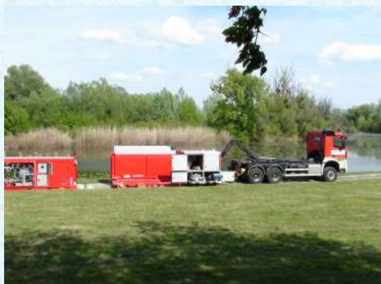
Mobil belvízátemelő szivattyúállomások bemutatója (Bodrogszerdahelyi Szivattyútelep)
