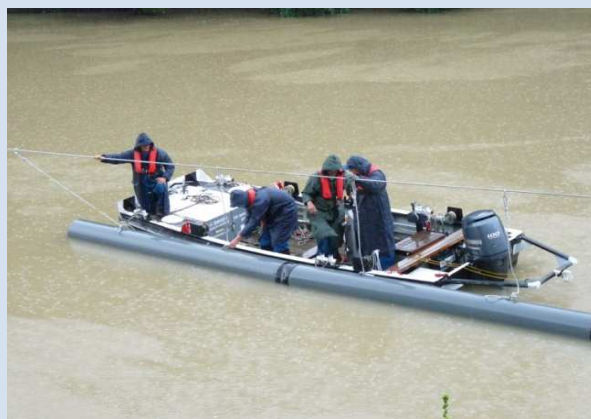
Merülőfal prototípusok telepítési és úsztatási próbája a Bodrogon Alsóberecki térségében
