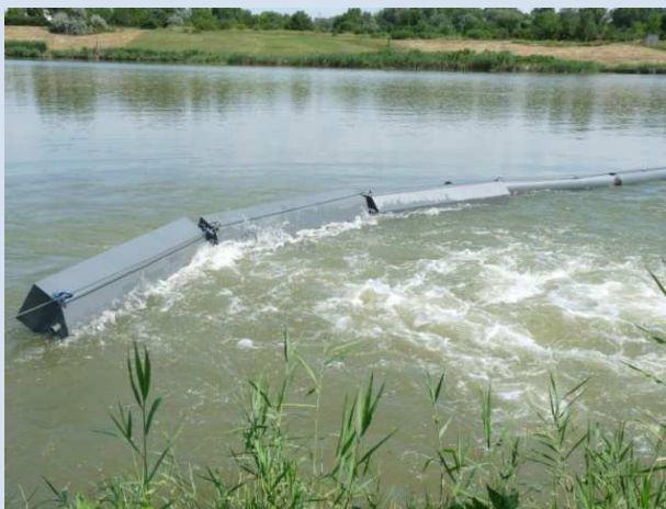
Ötszög és kör keresztmetszetű merülőfal prototípus elemek úsztatási próbája a Tiszalöki Vízlépcsőnél
