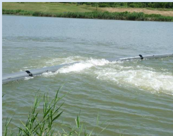
Ötszög és kör keresztmetszetű merülőfal prototípus elemek úsztatási próbája a Tiszalöki Vízlépcsőnél
