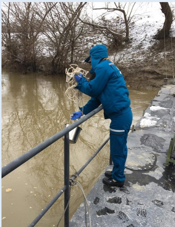
Mintavétel húzóköteles mintavevővel
