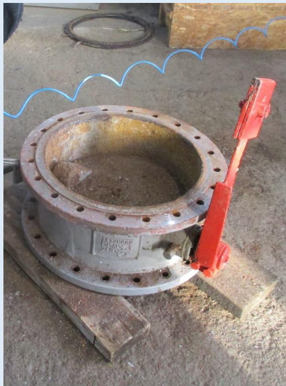
Poroszlói szivattyútelepen meghibásodott csappantyú
