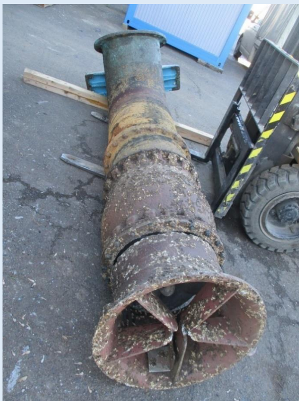
Újlőrincfalvai szivattyútelepen meghibásodott Agroflux 500E szivattyú
